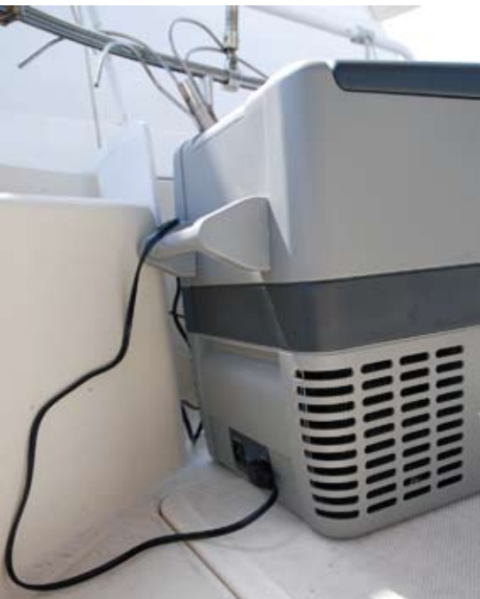
Kompresor mora uvijek imati nesmetanu ventilaciju kako se ne bi pregrijao
