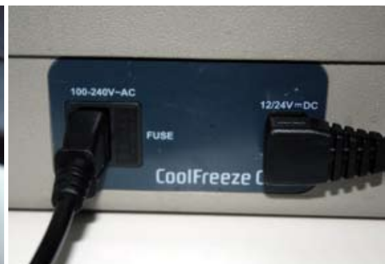
Priključak za napajanje izmjeničnom i istosmjernom strujom. Tu je i osigurač koji frižider štiti od pregaranja
